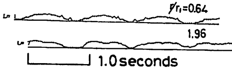
図 11 失速セルによる圧力変動
