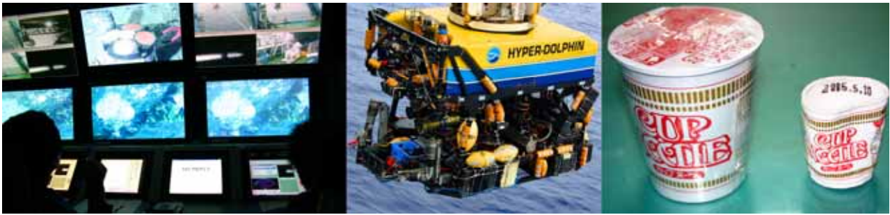
写真： 左より、HPD コントロールルーム、HPD、深海の圧力で圧縮された容器
