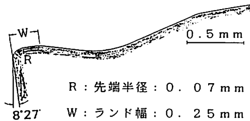
図4 使用した超硬工具の刃先断面
