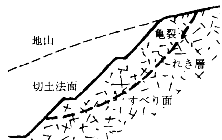
図-10 れき層の崩壊
