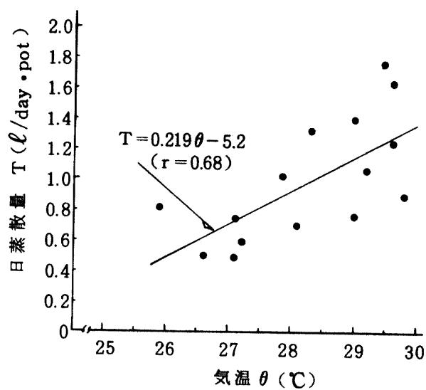
図7. サトウキビの日蒸散量と日平均気温との関係( $\text{pF} 3.4$ )
