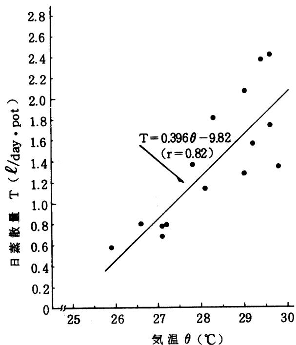
図4. サトウキビの日蒸散量と日平均気温との関係( $pF 2.3$ )
