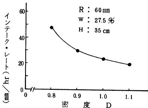
図-6 降雨強度 $60 \text{ mm hr}$ における密度とタン水開始後のインテーク・レートの関係
