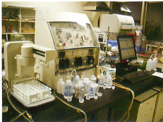
湿式自動化学水質分析装置 QuAAtro
