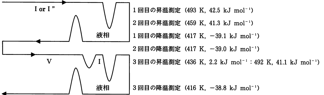
図1 [2, 6-(CH 3 ) 2 C 3 H 3 NH] 2 ZnBr 2 のDSC曲線の概略図
