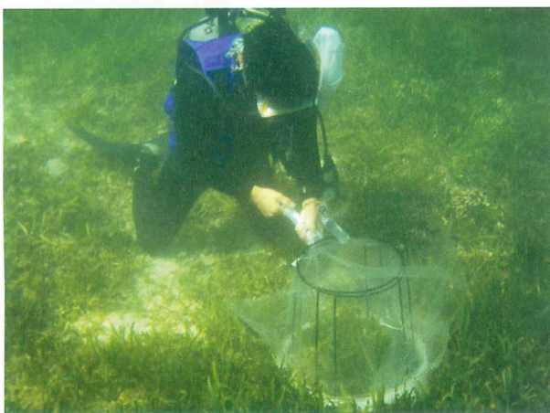
備瀬海岸でのチャンバー実験：干潮時の砂浜へチャンバーを設置（上）、満潮時に海草域のチャンバーから採水（下）
