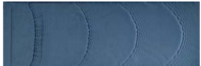
図 2 傾斜面を流下する Roll wave のシャドウグラフ像 Roll wave は左から右へ進行している。
