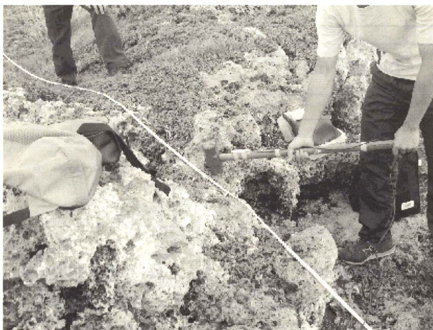
図17. 海食崖の上面における弾性波測定の様子
