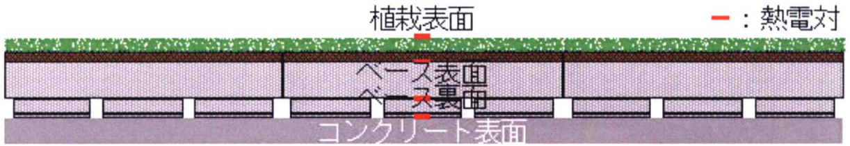
図2.3 屋上植栽ベース測定ポイント詳細
