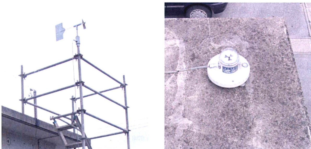
図 3.5 風速と日射量の測定状況
