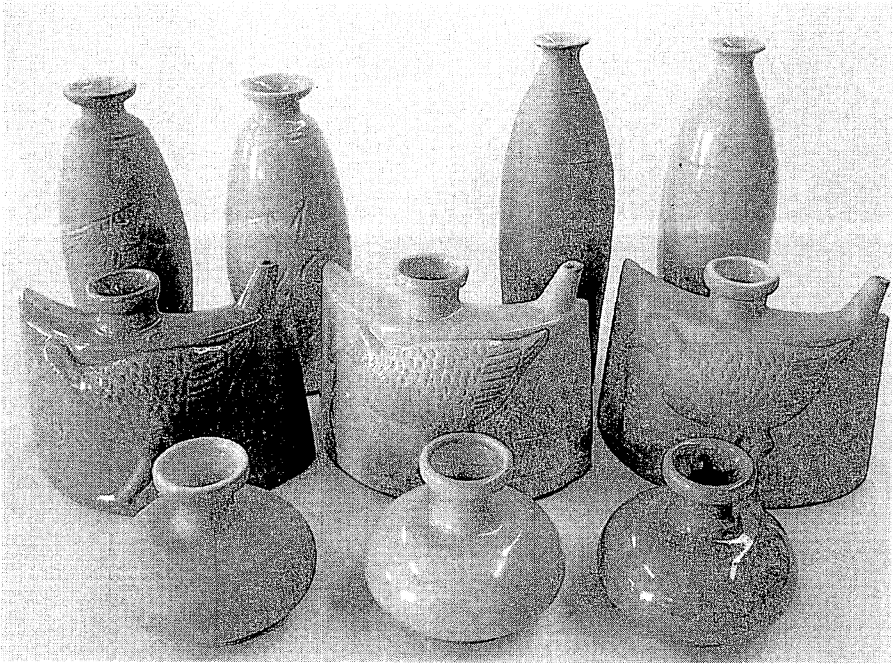
写真7 鑄込成形による試作例
