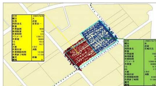
図2 車両搭載GPS を用いた農作業データ収集システム
