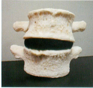
図2 試験体：第4腰椎，第5腰椎模型との間に，椎間板モデルを挟んで作製したもの。
