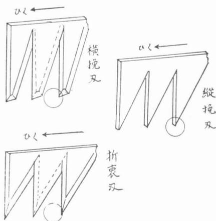
未熟練者の鋸断作業でよく見受けられることは、この両用の使いわけを混同したり、又は刃先の磨減した切味のよくない鋸を無理な力を加えて使用している事である。これは鋸の欠損の原因となるから、早急にめたてやすりと称する鋸の齒並によく合つた研磨具によつて目立するのであるが、更にめぶりをせねばならぬ。めぶりととは二つ一つの刃先を交互に鋸身の厚つさの二分の一程度左右に同等にふり分けることであつて、その度合は使われる材の硬軟によつて異なるものである。かくの如くめぶりにすることによつて鋸断による鋸屑の排出をよくし、且つ鋸と木材間の摩擦を円滑ならしめ鋸挽を容易にする。
