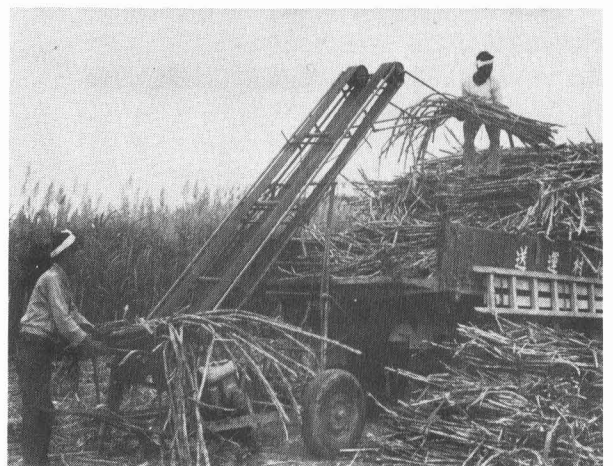
写真〔4〕搬出労働の合理化をめざし那覇市内の農機具製作所が試作した動力ケーブルのテスト風景
