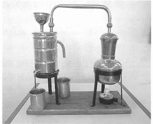
図1 アランピック蒸留器(左側:冷却槽,右側:蒸留釜)
