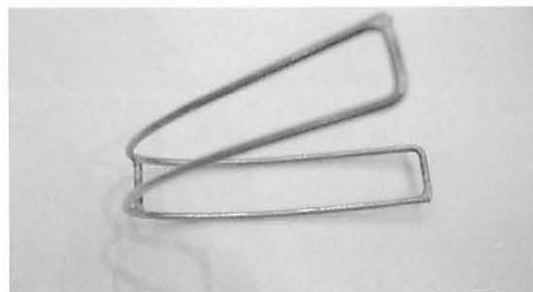
写真2 2011年9月撮影。靴の爪先には写真のような金具をはめて形を整えながら編む。このような道具を使うようになったのは最近だという。
