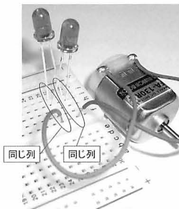
図15. 起電力発生確認
