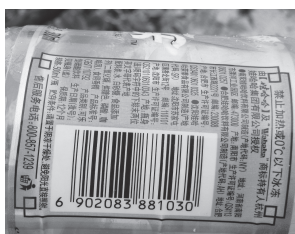
写真-9 ペットボトルのラベルのバーコード。最初の3桁が690なので、生産国は中国と識別できる
