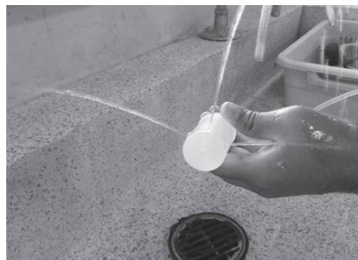
図6 エキスパートAで用いた密閉容器内の液体に加えた力が面に垂直に加わることを説明する図
