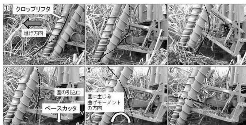
図6 向刈りにてサトウキビが損傷する状況
