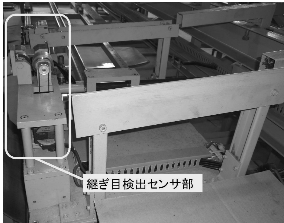
図 3 継ぎ目検出ユニットと継目検出方法
