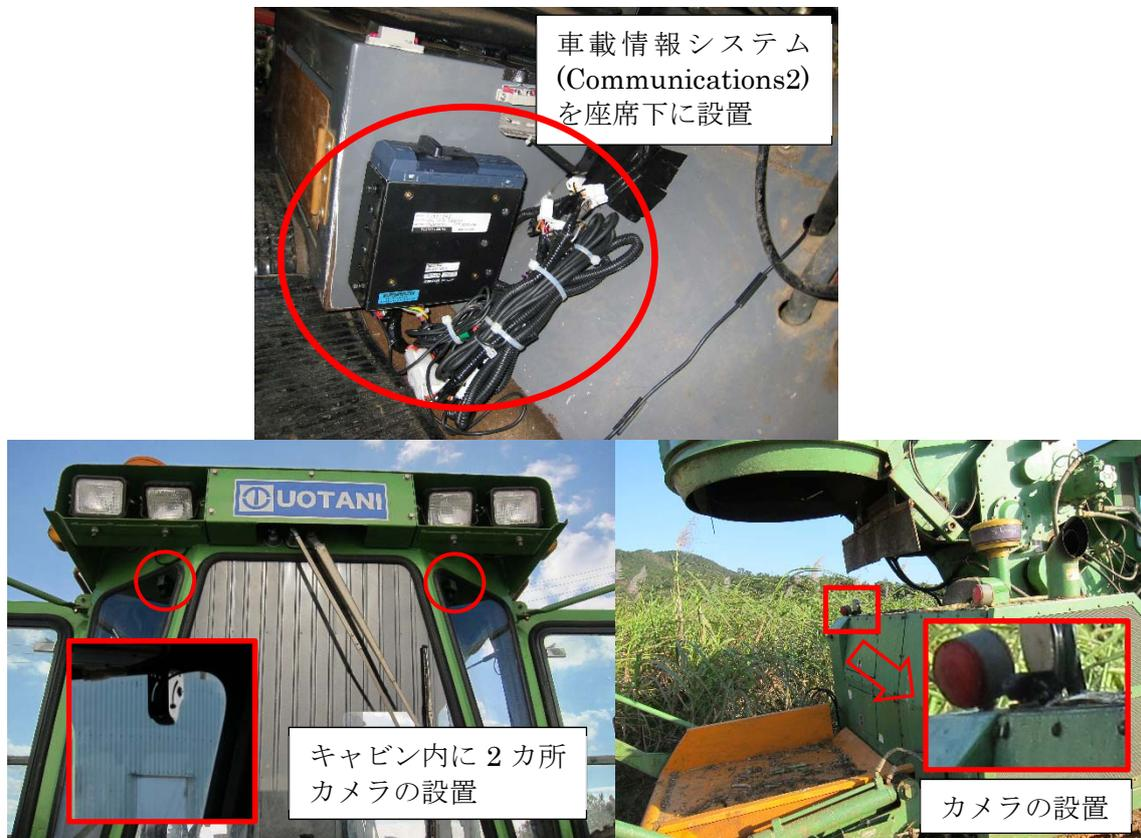
図 2 車載情報システムおよびドライブレコーダー（カメラ）の設置状況
