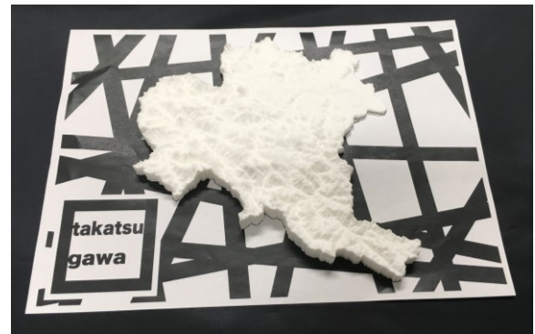
図-2 3Dプリンターで作成した高津川流域の3D立体模型
