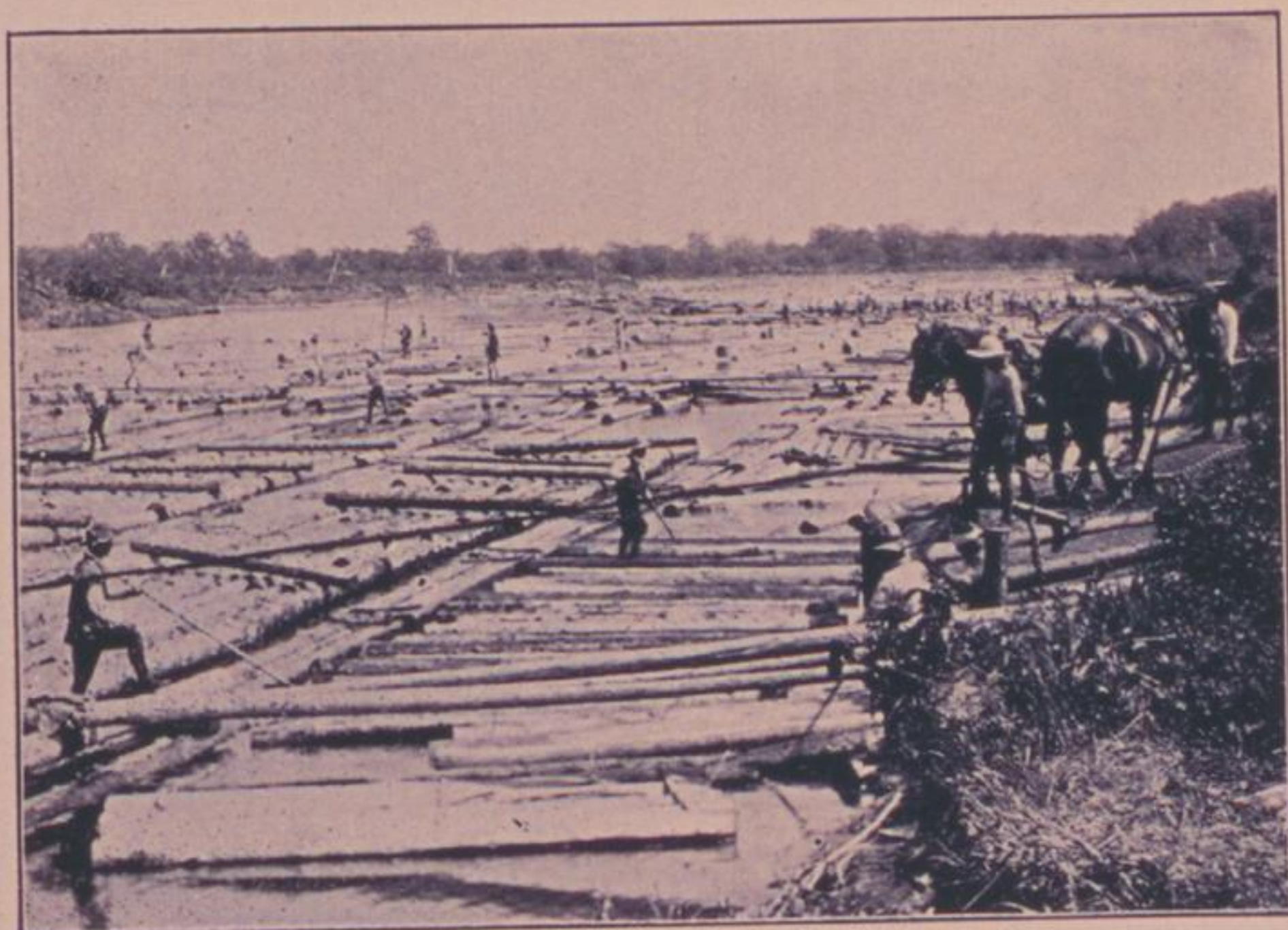
留多加川の流送状況 留多加川に於ける木 材の流送状況にして 同所に流送せられた る木材は一旦集積せ られ、更に所要地に 發送せらる
