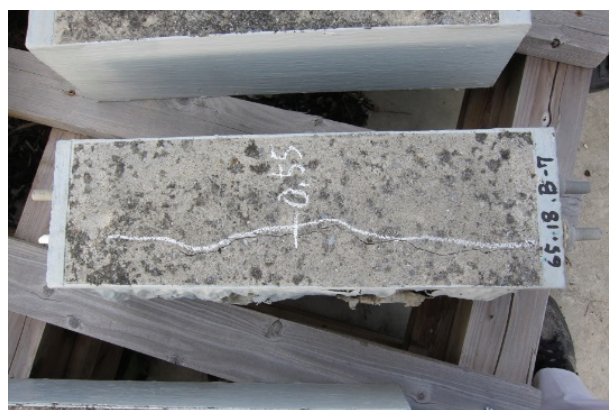
写真-7 ひび割れの発生していた65-B供試体
