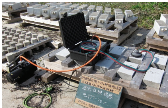
写真-5 透気係数試験状況
