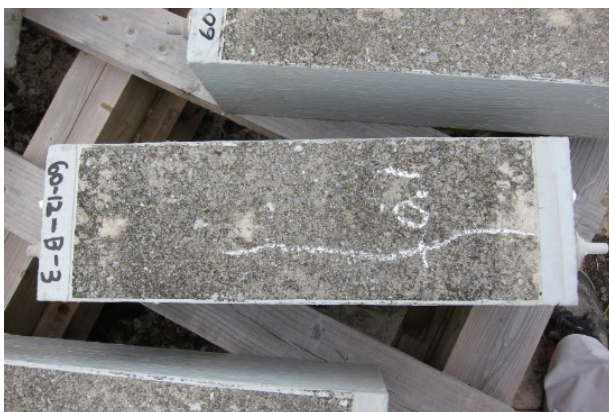
写真-6 ひび割れの発生していた60-B供試体
