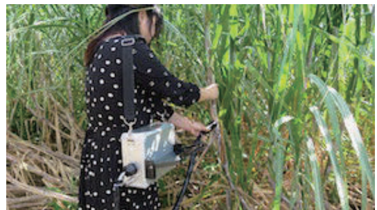
Fig. 2 サトウキビの非破壊糖度センサーの開発
