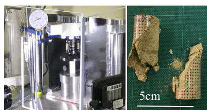
Fig.1 一軸圧縮試験と破壊後のベレア砂岩供試体
