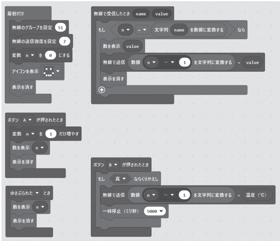
図7 複数の micro:bit を中継させた遠隔温度測定プログラム
