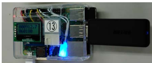
図4 Wi-Fi パケットセンサー
