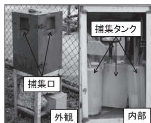
写真1 改良型土研式飛来塩分捕集器の概要
