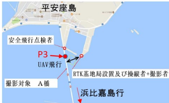
図-14 UAV撮影時の飛行ルート
