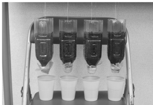
写真6. 土の保水力の実験の様子。
