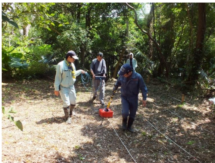
写真1 2014年根謝銘グスクにおける地中レーダー探査
