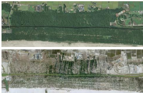
写真-1 津波来襲前(上)と後(下)の防潮林帯の比較
