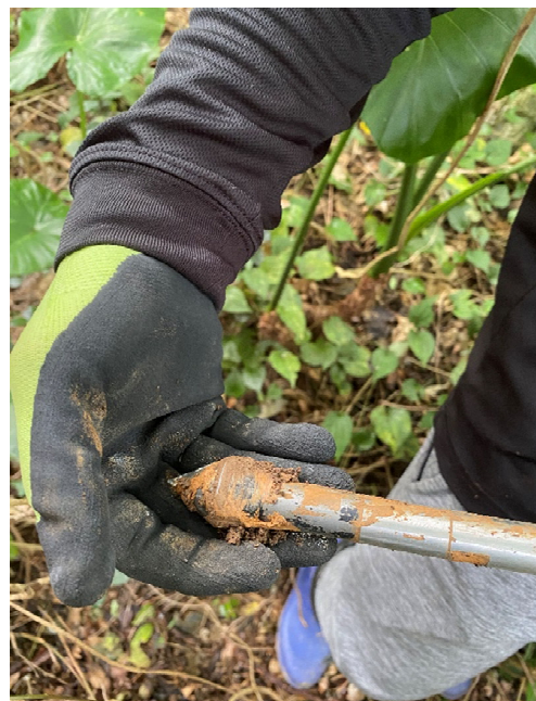
図 5 貫入試験機先端コーンに付着した赤色の粘土 (N9 地点、大河内撮影)
