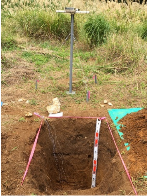
図4 地点Oにおける石灰岩の設置地点 (空中1.5 m, 土層-50 cm, 土層-100 cm)
