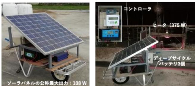
図6. 自作の移動式ソーラーパネル
