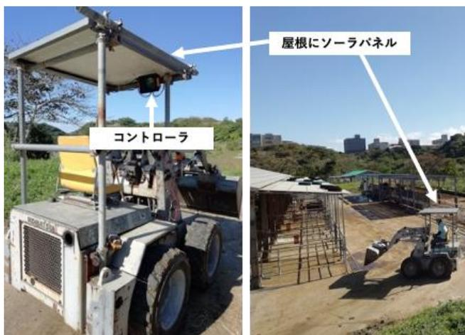
図7. ソーラーパネルを設置したミニローダ
