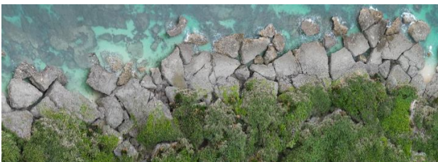
図-5 断崖をなす琉球石灰岩の割裂状況
