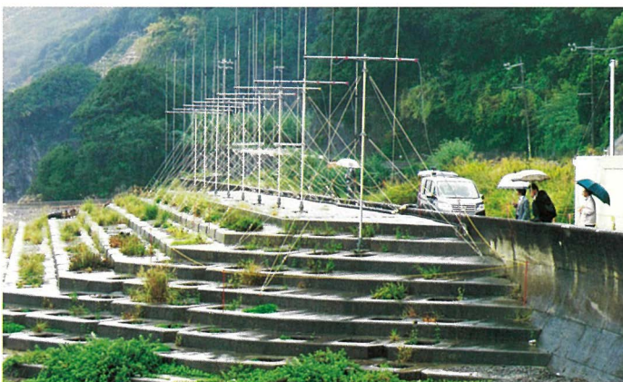
現在、津波観測研究のために和歌山県美浜町に設置している海洋レーダ
