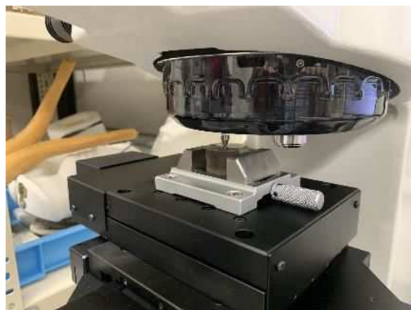
図 2.2.13 マイクロビッカース硬さ試験
