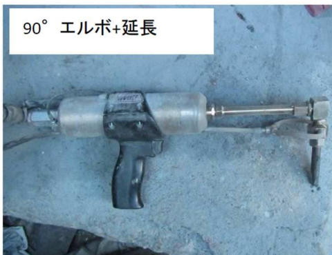
図 3.2.7 開発した各種エクステンション
