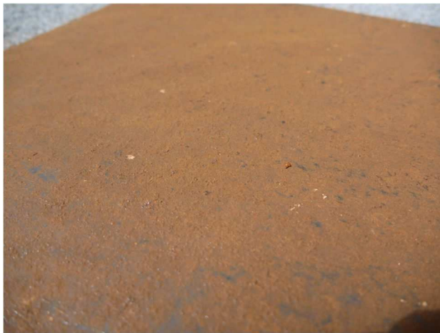
図 2.2.5 使用したさび鋼板の表面状況
