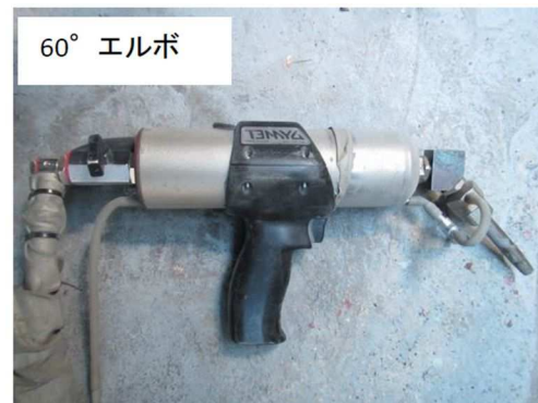
図 3.2.7 開発した各種エクステンション
