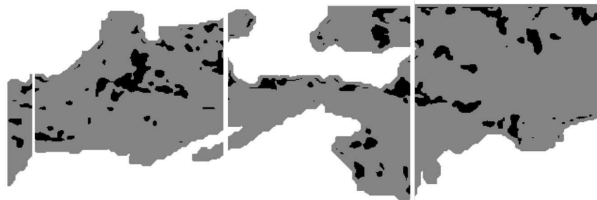
溶射皮膜の二値化処理後画像 (灰色：皮膜部，黒色：空隙部，空隙率 10.1%)
